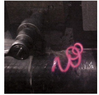
Figura 4: El metal extruido se corta desde el exterior del tubo soldado
