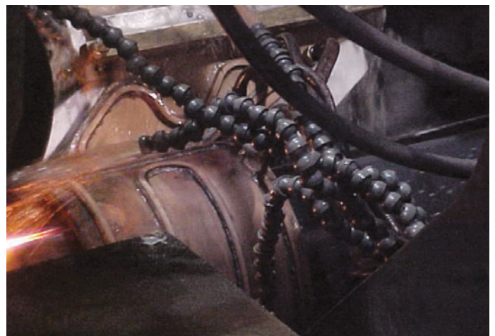
Figura 2: El tubo pasa por la bobina de inducción de alta frecuencia
