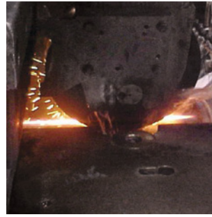
Figura 3: El tubo sale de la bobina de inducción de alta frecuencia y pasa por los rodillos de presión de soldadura
